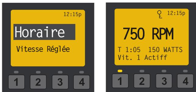
**Remarque :** La pompe ne fonctionnera aux vitesses programmées selon l'horaire qu'une fois le bouton **Start/Stop** (voyant DEL allumé) enfoncé de façon à régler la pompe en mode horaire.
