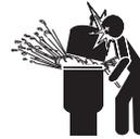
**PRESSIION DANGEREUSE : RESTER À L'ÉCART DE LA POMPE ET DU FILTRE PENDANT LE DÉMARRAGE**
